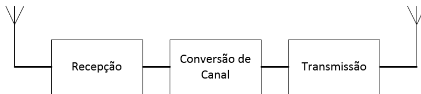
Figura 10 – Diagrama em blocos de um sistema de retransmissão de televisão digital.
