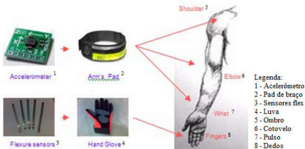
Figura 3 – Disposição dos sensores flex e do acelerômetro no protótipo a serem utilizados pelo usuário do projeto (Swee et al. 2007).
