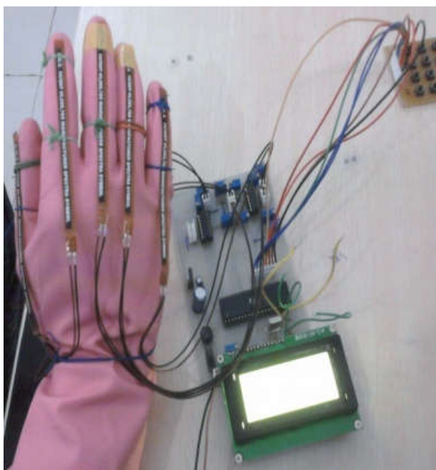
Figura 2 – Protótipo da luva realizada por (Kadam et al. 2012)
