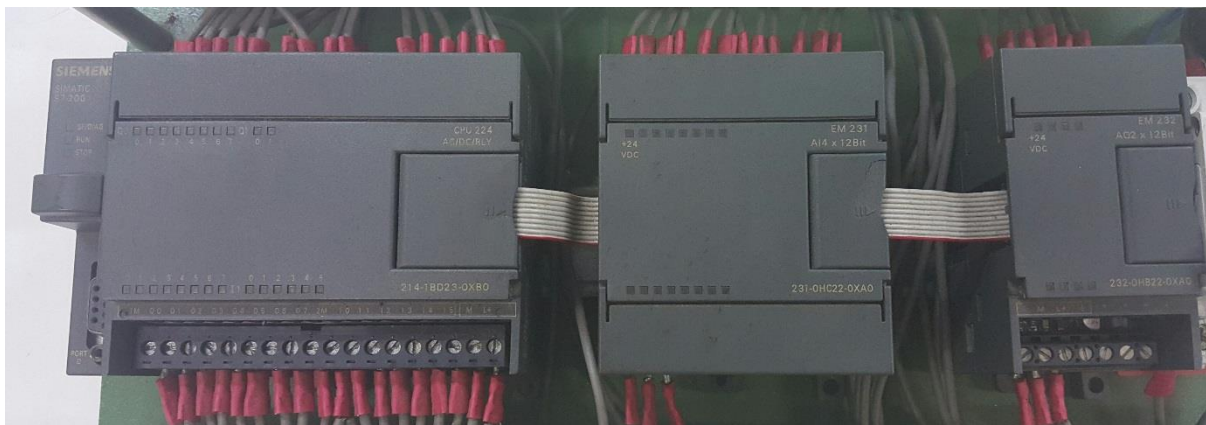
Figura 6-CLP S7200 CPU 224 com os módulos de expansão EM231 e EM232
