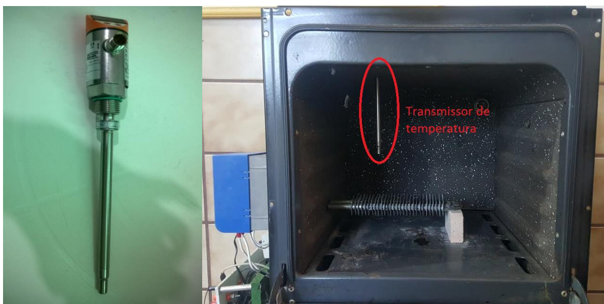
Figura 10- conjunto transmissor de temperatura TRT2432 da IFM e sensor PT100
