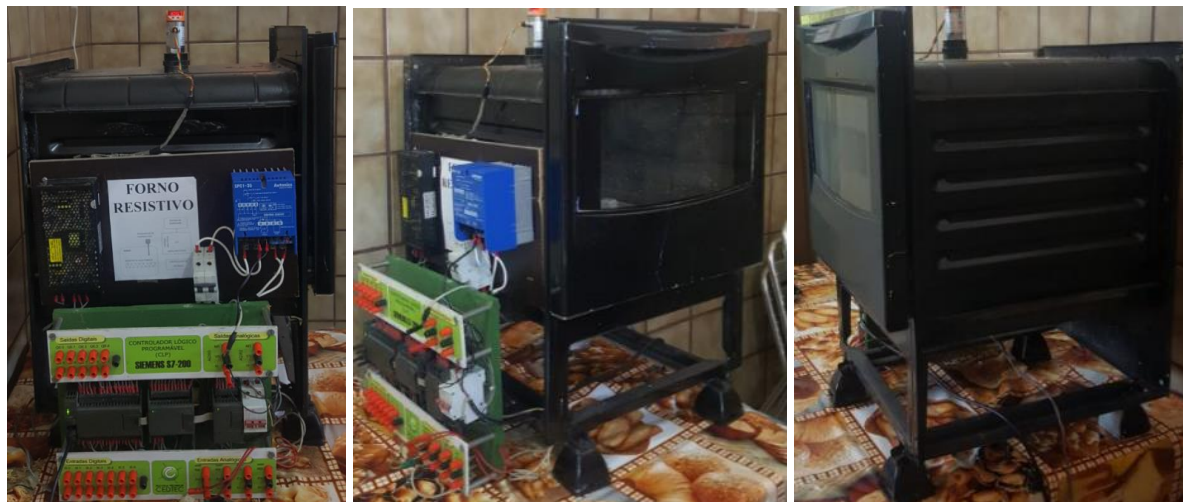
Figura 5-Protótipo do Forno de aquecimento confeccionado
