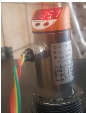
Figura 11-IHM do transmissor de temperatura TRT2432 da IFM
