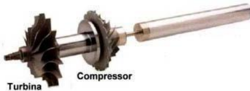
Figura 5 – Compressor e Turbina
