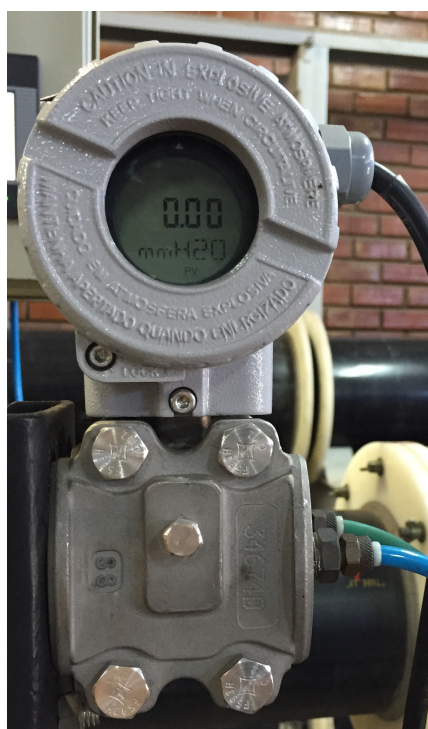
Figura 4 – Transmissor de pressão diferencial
