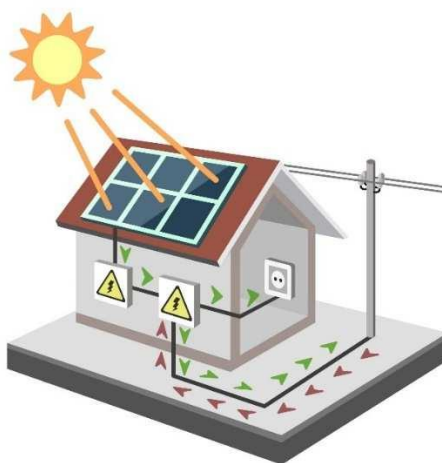
Figura 20 – Funcionamento de um sistema fotovoltaico on-grid
