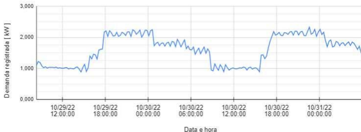
Gráfico 9 – Demanda medida em kW referente ao quadro de distribuição QD10 entre os dias 29 e 31 de outubro de 2022
