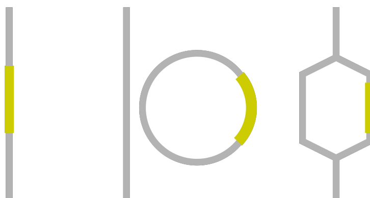
Figura 7 – Ilustração esquemática de um modulador do tipo linha, modulador do tipo anel e modulador do tipo Mach-Zehnder.
