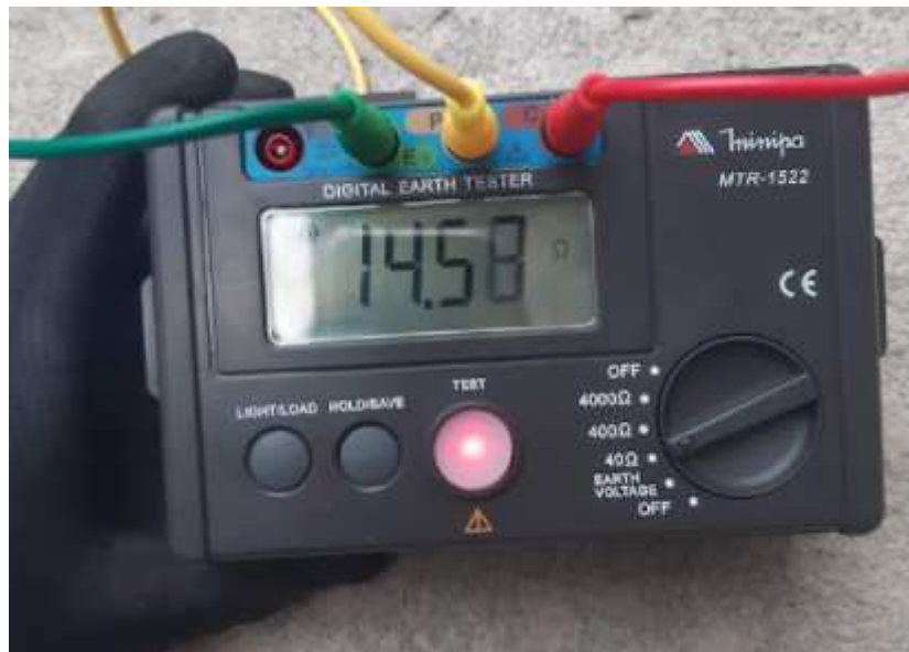
Figura 21 – Medição de interferência para procedimento de medição de resistividade.
