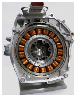
Figura 3.32 - Motor PMSM de fluxo radial do Honda IMA
