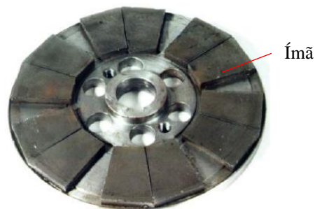
Figura 4.16 - Rotor interno de seis polos para o motor experimental de 2.5 kW
