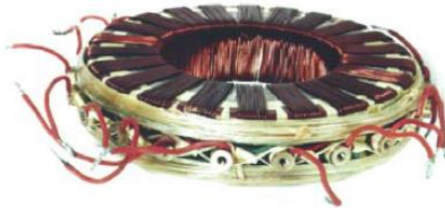
Figura 4.15 - Estator toroidal com enrolamento de 11 fases
