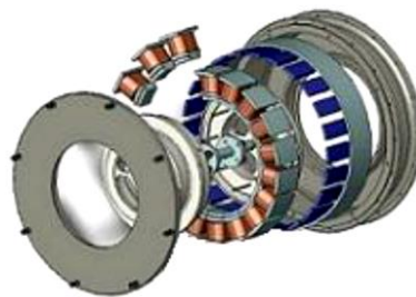
Figura 3.31 - Motores de ímãs permanentes de fluxo radial
