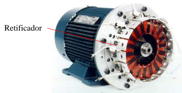
Figura 4.13 - Motor Torus experimental de 2,5 kW
