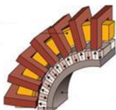
Figura 3.36 - Motores de ímãs permanentes de fluxo transverso
