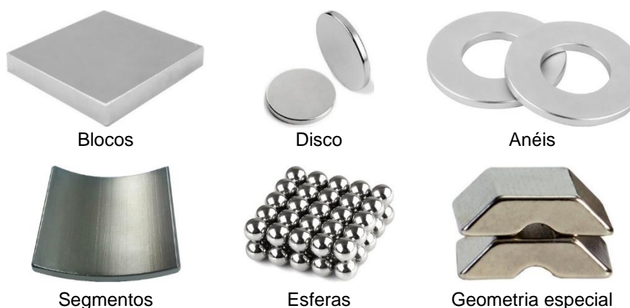
Figura 5.9 - Formas regulares dos ímãs permanentes de neodímio
