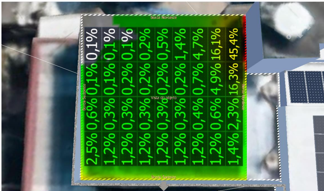
Figura 14 – Sombreamento dos módulos da Face 1.1 do telhado da PIBG
