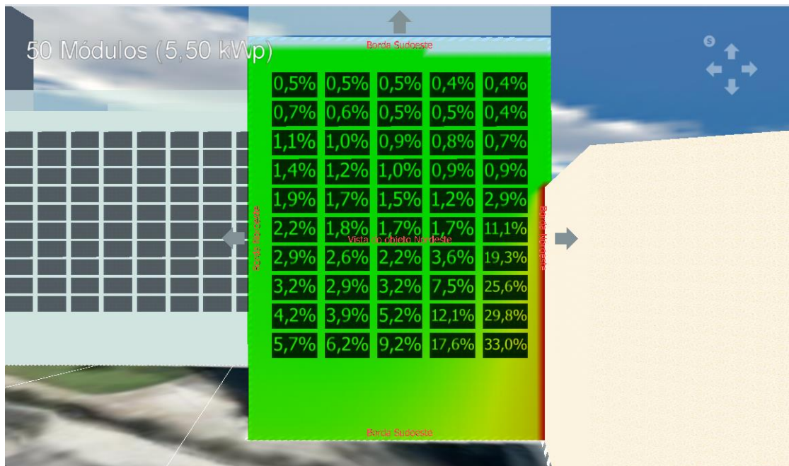
Figura 32 – Sombreamento dos vidros fotovoltaicos da Face 2.3 da fachada da PIBG
