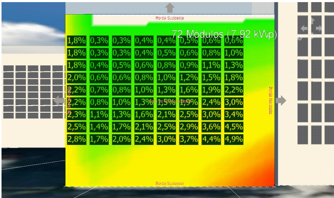
Figura 34 – Sombreamento dos vidros fotovoltaicos da Face 2.5 da fachada da PIBG
