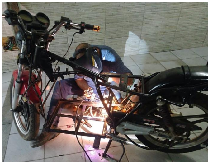
Figura 23 – Soldagem do suporte das baterias e motor
