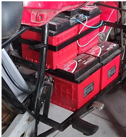
Figura 25– Disposição do banco de baterias
