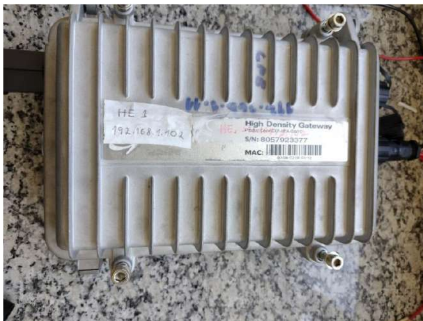
Figura 11 – Dispositivo PLC da Corinex usado nos experimentos
