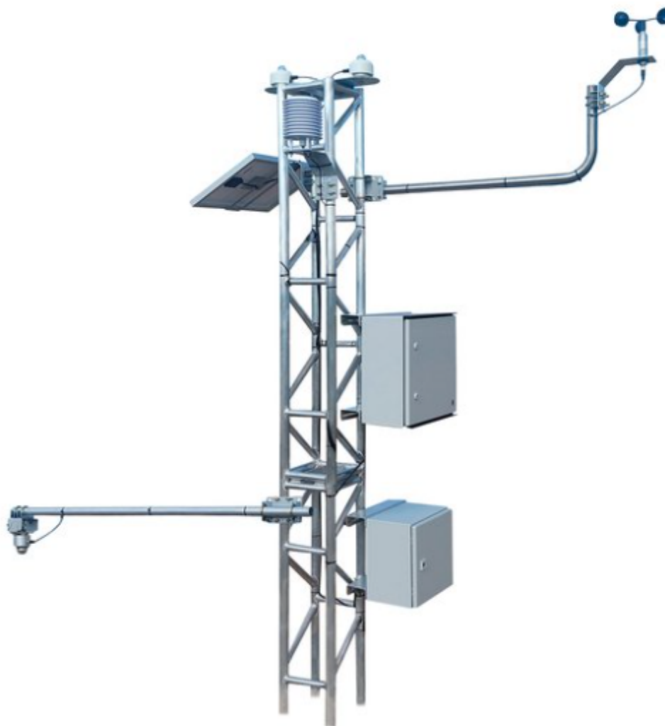
Figura 13 – Exemplo de uma estação solarimétrica
