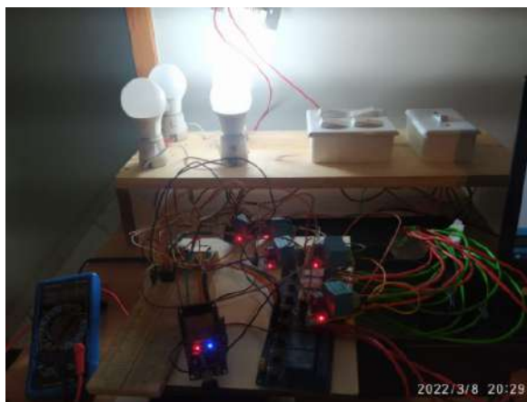
Figura 32 – Protótipo e página HTML na situação em que apenas a lâmpada 2 está acesa.
