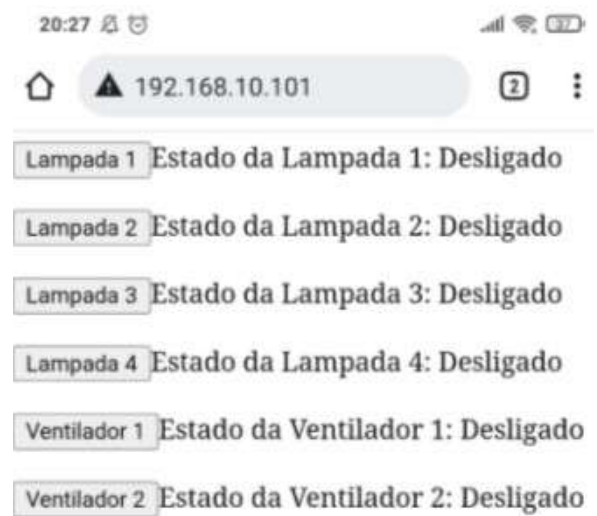
Figura 31 – Protótipo e página HTML na situação em que todas as cargas estão desligadas.
