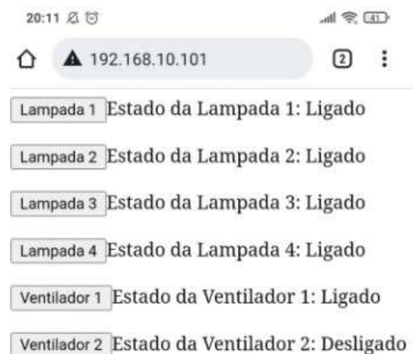
Figura 33 – Protótipo e página HTML na situação em que todas as cargas estão ligadas.
