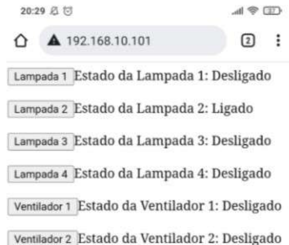
Figura 32 – Protótipo e página HTML na situação em que apenas a lâmpada 2 está acesa.
