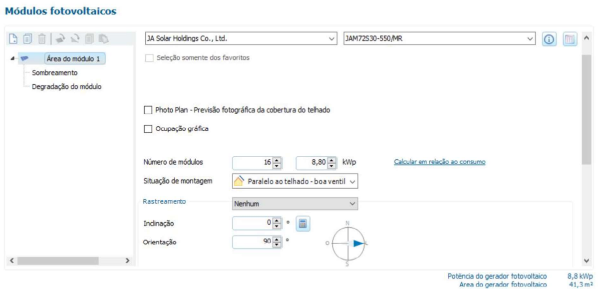
Figura 27 - PV*SOL: Janela de definição do arranjo fotovoltaico
