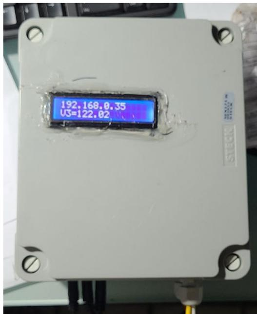
Figura 14 – Medidor de energia fechado.
