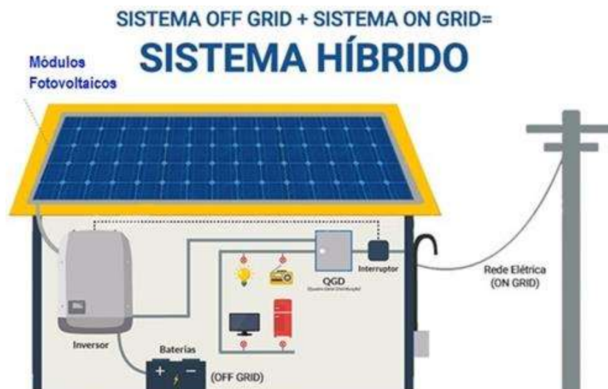
Figura 5 – Componentes de um sistema fotovoltaico híbrido
