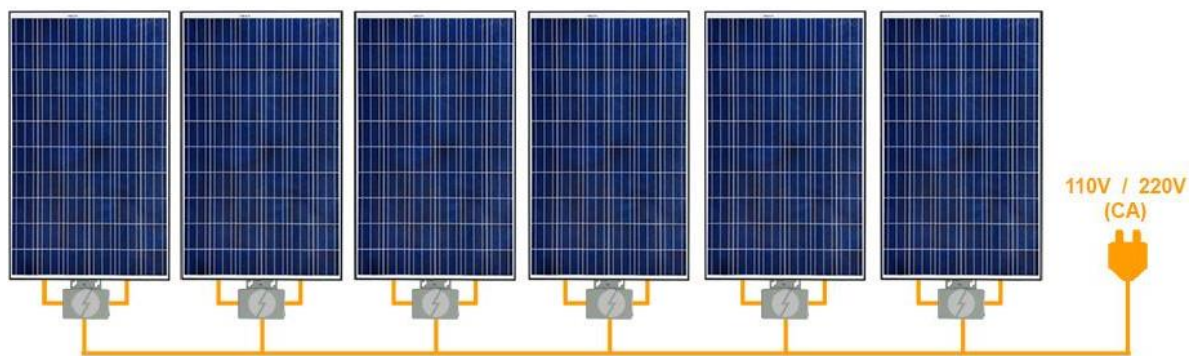
Figura 2 — Esquema de ligação dos painéis com microinversores
