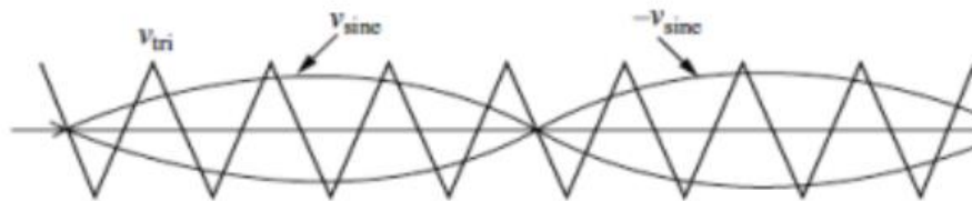
Figura 18 — Portadora e moduladoras da modulação SPWM unipolar
