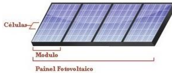
Figura 15 – Subdivisões de um painel fotovoltaico
