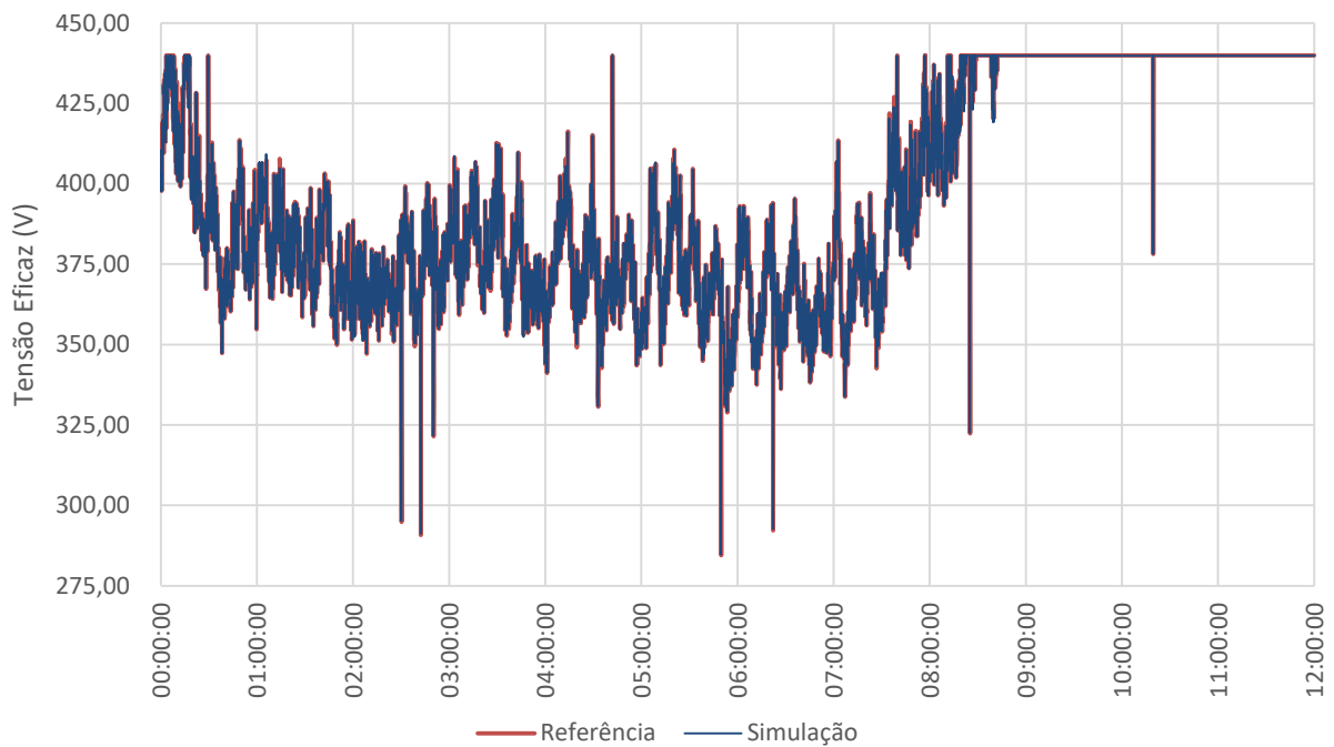
Gráfico 22 – Comportamento da fundamental da tensão de linha eficaz simulada com a relação V/f linear
