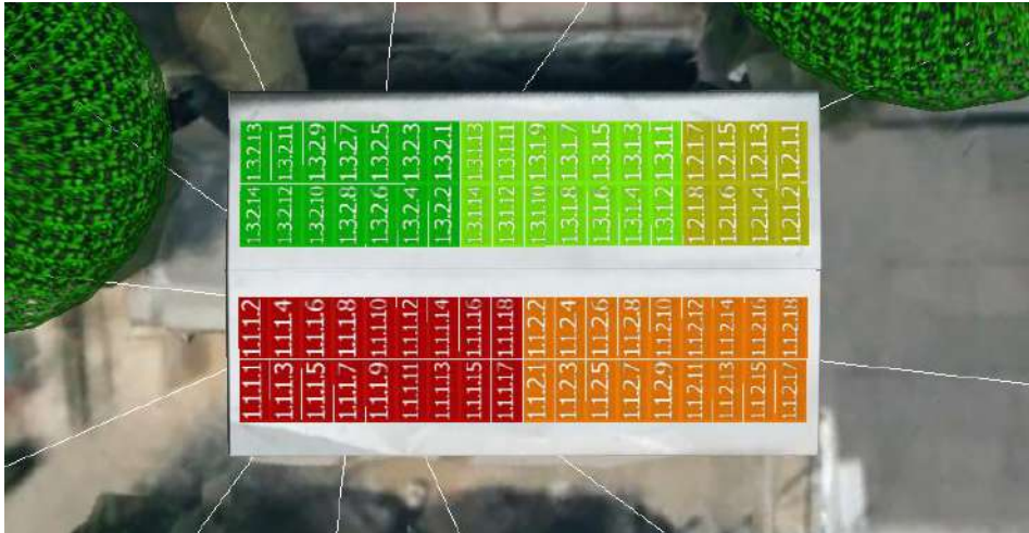
Figura 22 — Módulos por MPPT em Planta Baixa
