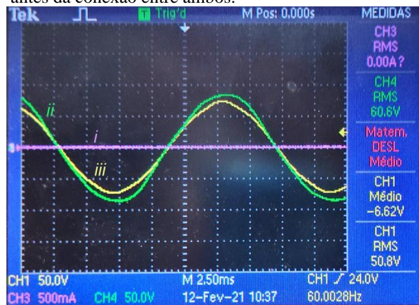
Figura 21 – Tensão gerada pelo inversor (verde, ii) e tensão da rede (amarelo, iii) antes da conexão entre ambos.
