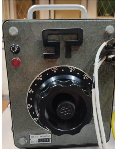
Figura 20– Autotransformador monofásico de tensão variável.
