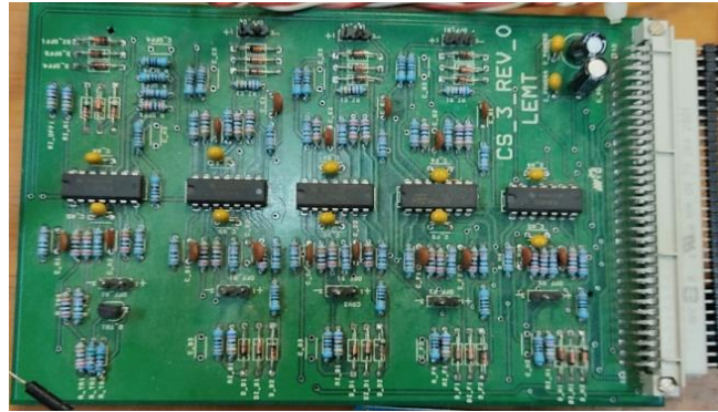
Figura 11 – Placa de condicionamento de sinais
