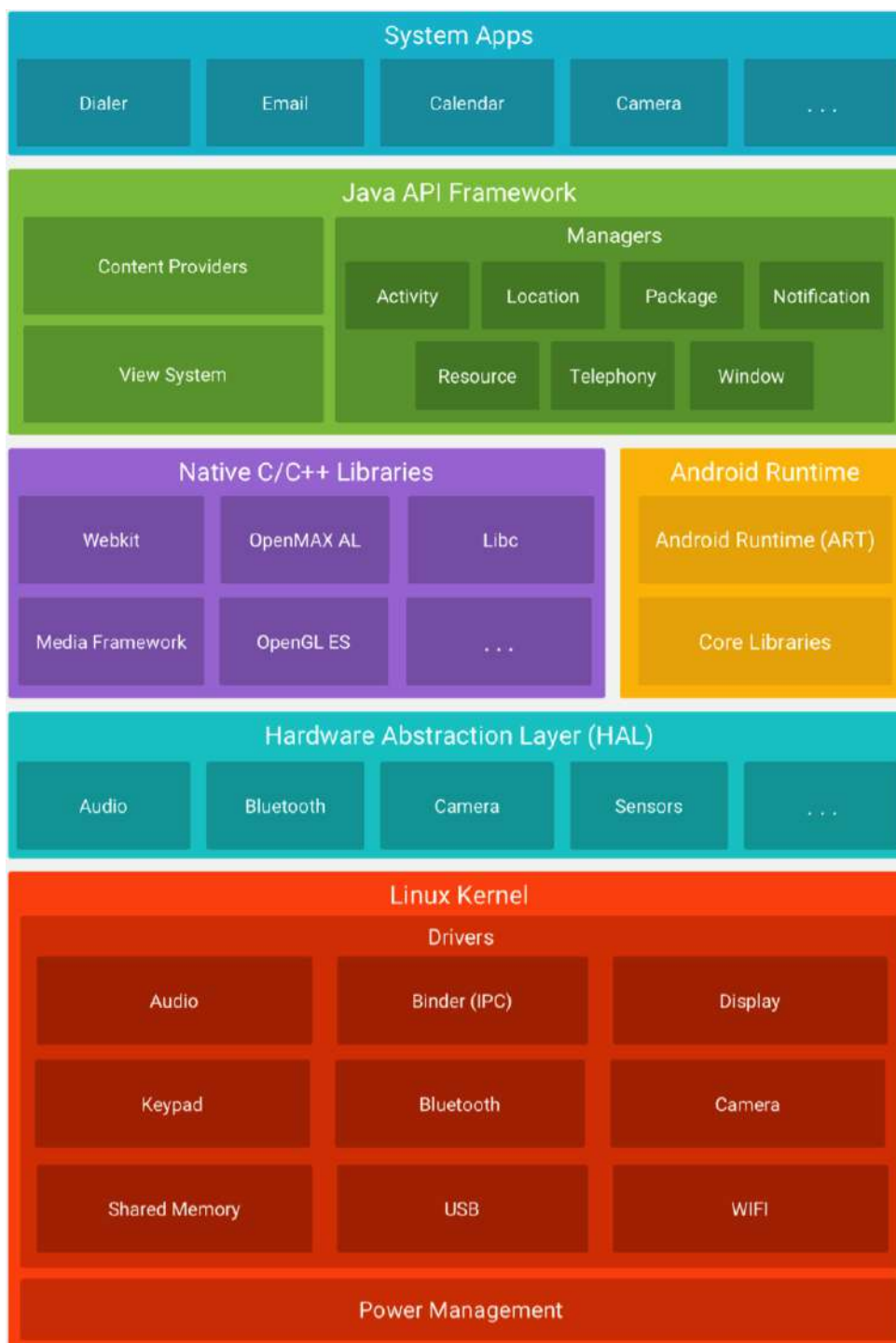
Figura 36 – Principais Componentes da Plataforma Android
