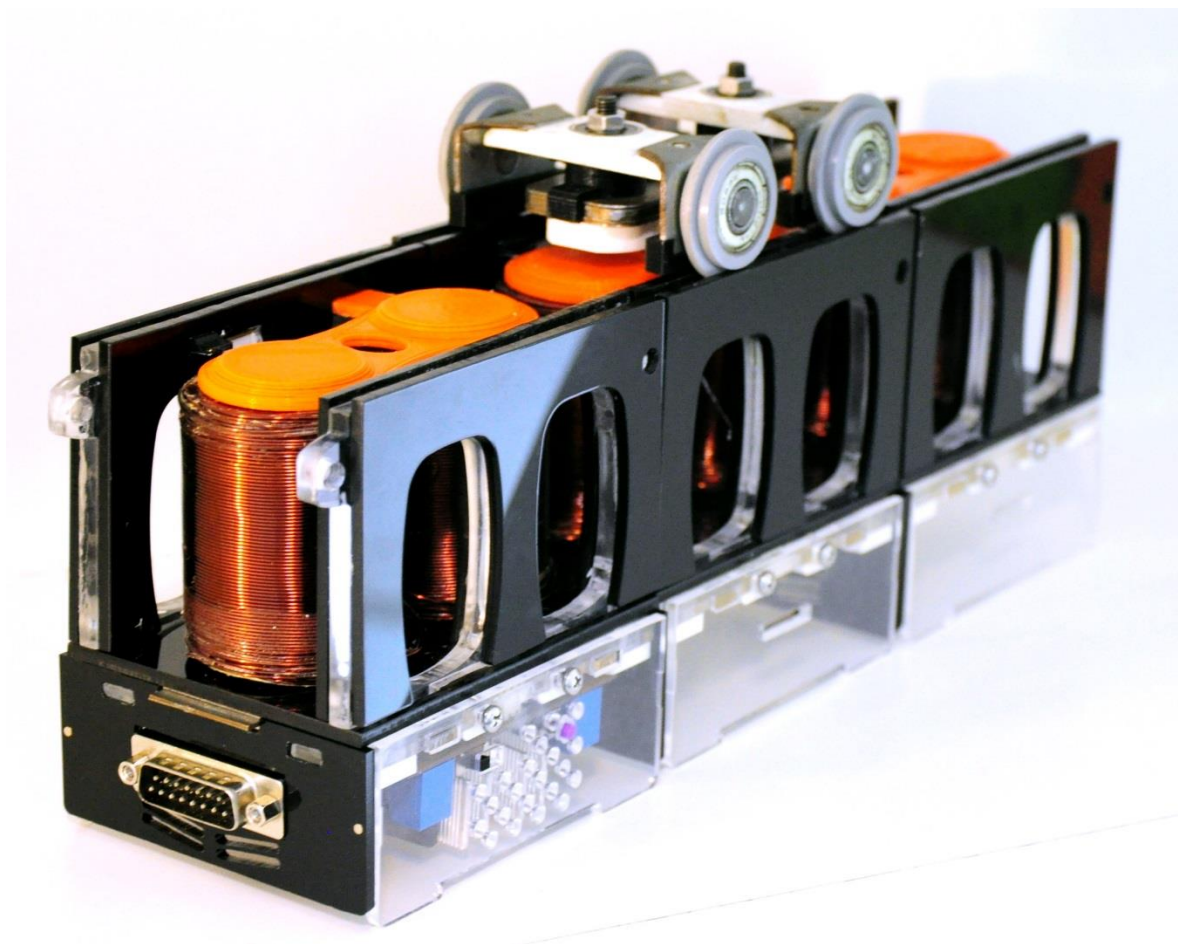
Figura 35 – Montagem dos Módulos de Pista com o Veículo.
