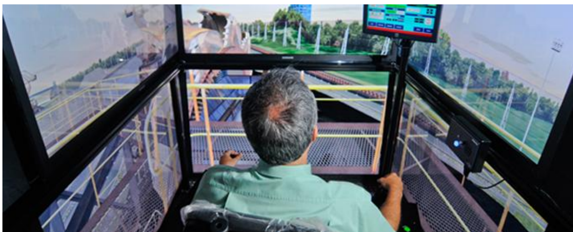
Figura 2 – Simulador de operação da recuperadora de minério
