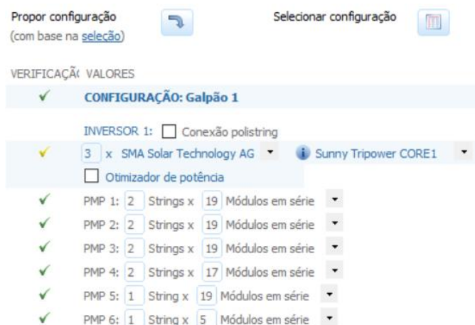
Figura 25 - Resultado do dimensionamento de inversor para determinada quantidade de módulos FV.
