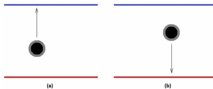
Figura 23 – Linhas bases de referência usadas na detecção da direção do movimento.
