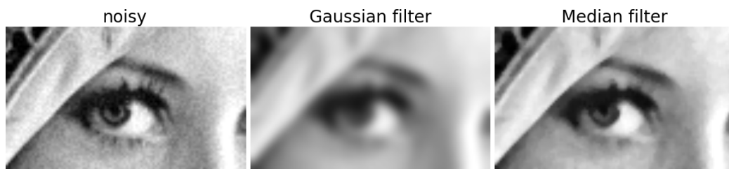
Figura 22 – Exemplo da aplicação do Filtro Gaussiano
