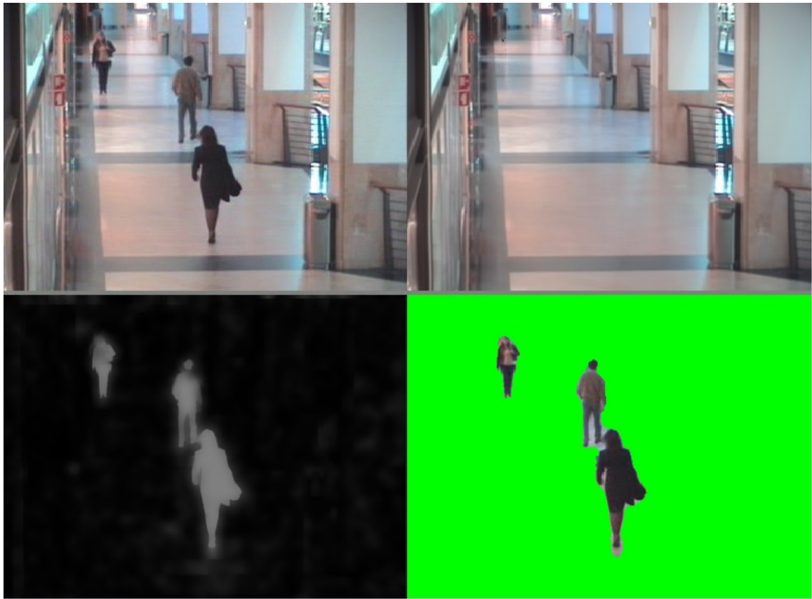
Figura 5 – (acima à esquerda) Imagem original. (acima à direita) Distância. (abaixo à esquerda) Background . (abaixo à direita) Foreground .
