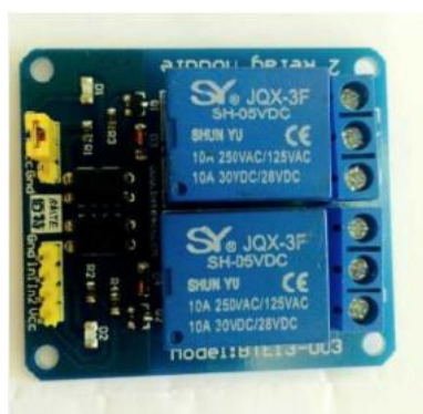
Figura 9 – Placa de dois canais com os relés de 10A acionados por um sinal 5V.
