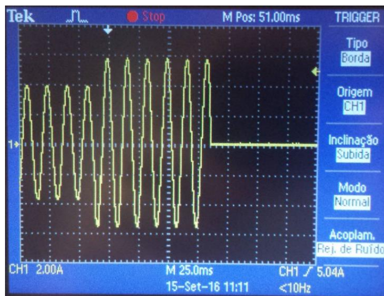
Figura 17 – Gráfico de atuação da proteção por sobrecargas
