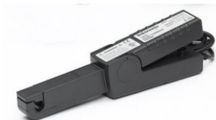
Figura 14 – Ponteira de corrente utilizada para acoplamento direto no osciloscópio.
