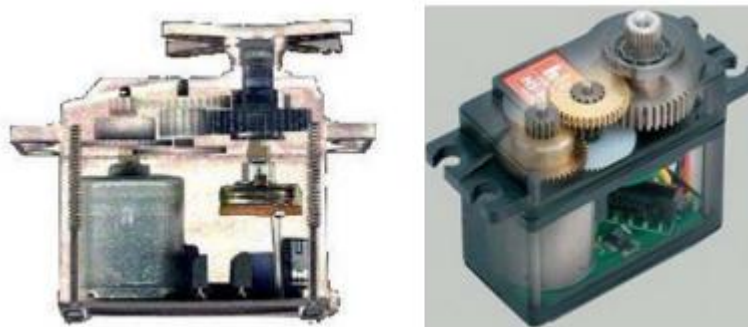
Figura 16 – Posicionamento dos componentes na caixa do servo motor.
