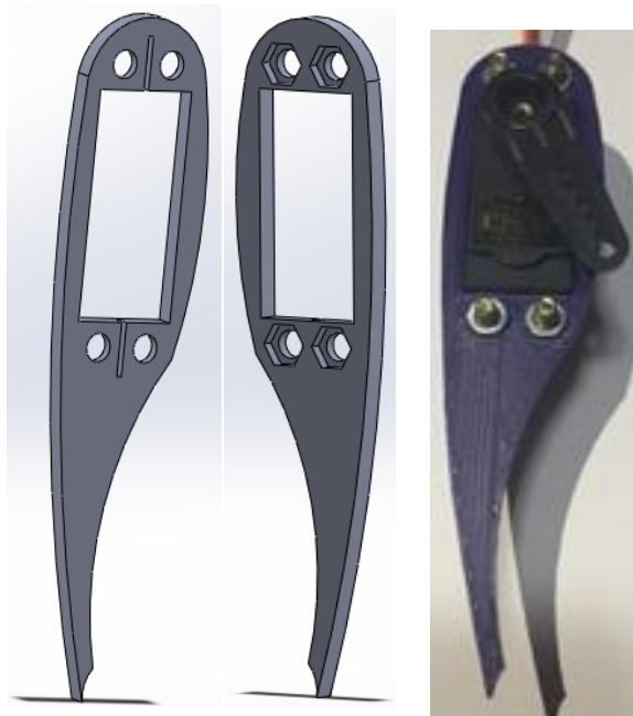
Figura 39 – Tíbia desenhada no SolidWorks e fabricada na impressora 3D.
