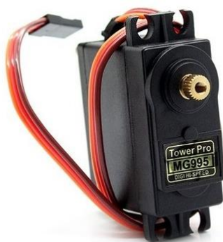
Figura 17 – Motor servo usado neste projeto e seus fios para conexão.
