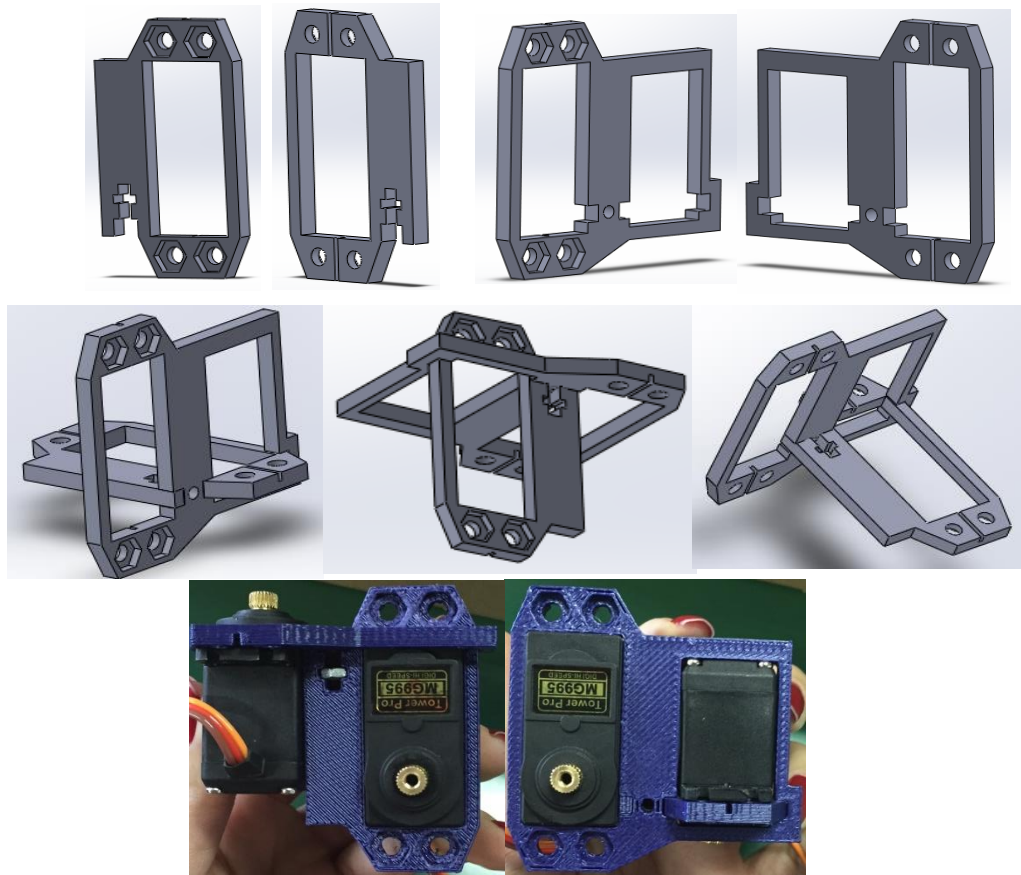
Figura 37 – Peças que formam a coxa feitas no SolidWorks (separadas e montadas) e as fabricadas na Impressora 3D, também montadas.
