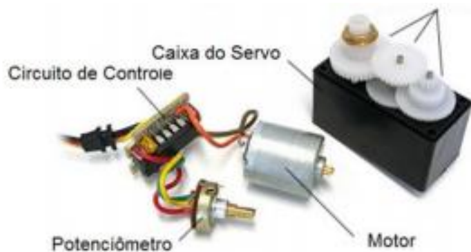
Figura 15 – Componentes de um servo motor.
