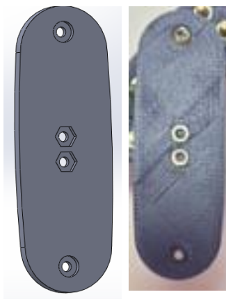
Figura 38 – Fêmur desenhado no SolidWorks e fabricado na impressora 3D.
