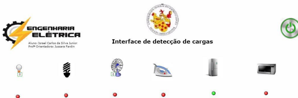
Figura 52 - Interface de detecção durante a ligação do refrigerador
