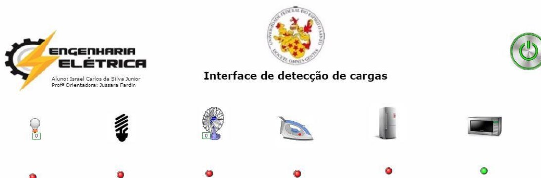
Figura 55 - Interface de detecção durante a ligação do forno de micro-ondas
