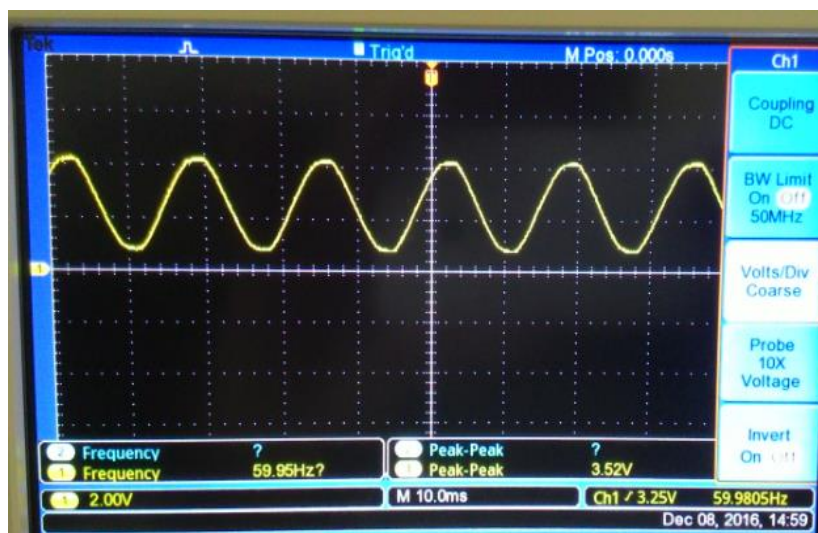
Figura 13 - Sinal senoidal de entrada da tensão no microcontrolador
