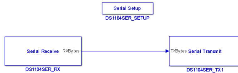
Figura 20 - Circuito embarcado no dSPACE para transmissão e recepção
