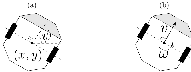
Figura 24 – Representação das grandezas associadas ao robô Pioneer 3 AT : (a) odometria e (b) velocidades.
