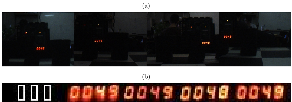
Figura 35 – Imagem das quatro câmeras mostrando o número exido pelos displays (a), e corte feito na imagem para facilitar a leitura dos valores (b).
