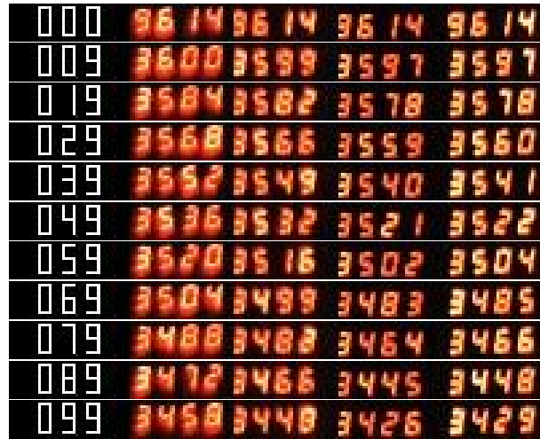
Figura 37 – Imagens dos displays do experimento com intervalo de amostragem igual a 36 segundos, em 10 instantes igualmente espaçados após o início.
