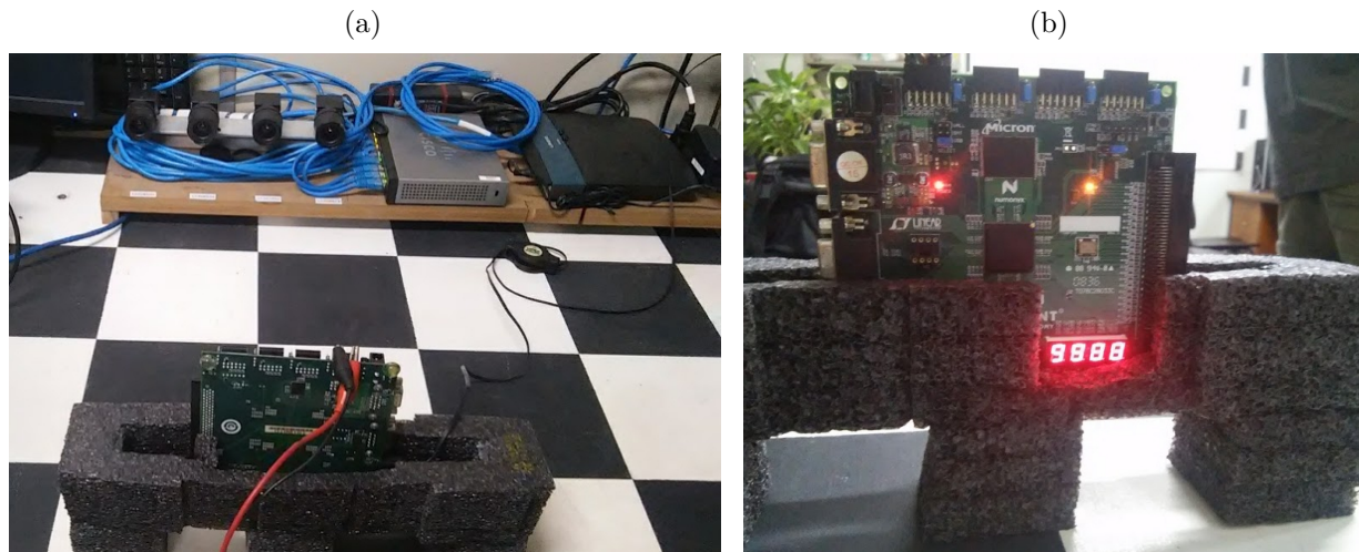
Figura 34 – Montagem das câmeras e da placa com FPGA para o experimento de validação do serviço de sincronismo.
