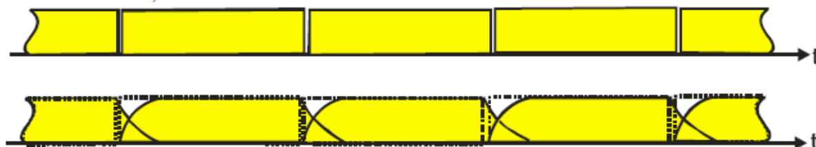
Figura 25: Representação da comunicação sem intervalo de guarda e sem prefixo cíclico
