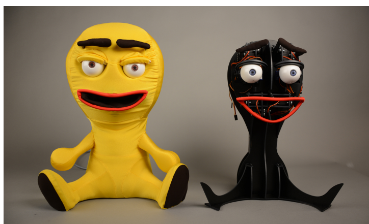
Figura 4 – Parte interna e aspecto externo do robô Ono.
