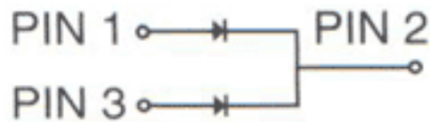
Figura 25: Esquema elétrico do diodo 16A8C [26].
