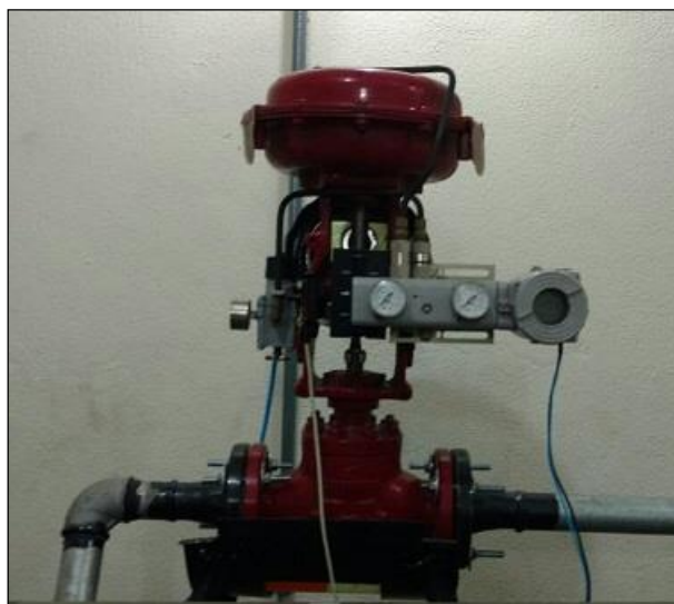
Figura 8 – Válvula destinada ao estudo de cavitação
